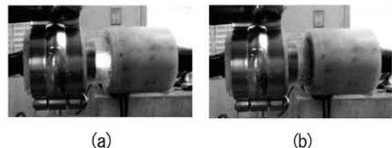
図 2-2 放電の様子 ((a) 放電時 (b) 非運転時)
