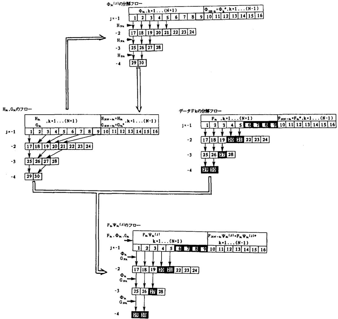
図2. 1 ウェブレット変換の演算フローチャート
