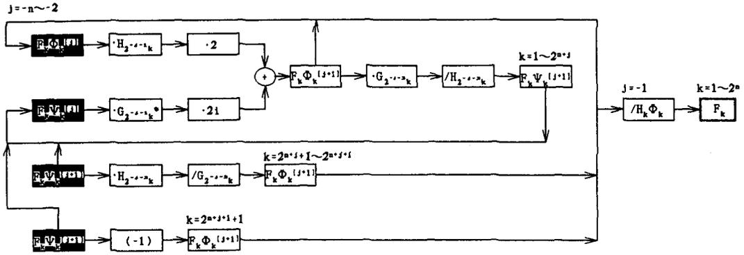
図2. 2 逆ウェーブレット変換の演算フローチャート
