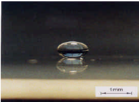
写真 超撥水コーティングを施した ガラス板上の水滴
