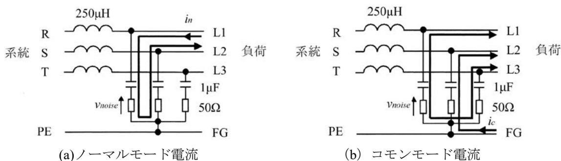
図 5.1 LISN による伝導ノイズ測定
