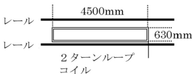
図 2.12 ATS ループコイルの設置状況
