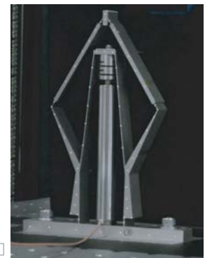
第12図 最適化された変位拡大機構形状とアクチュエータ 15)
