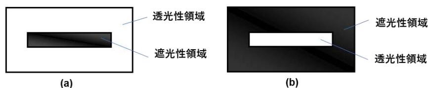
図 5-1 2種類のマスクタイプ、(a) Bright Field マスク、(b) Dark Field マスク
