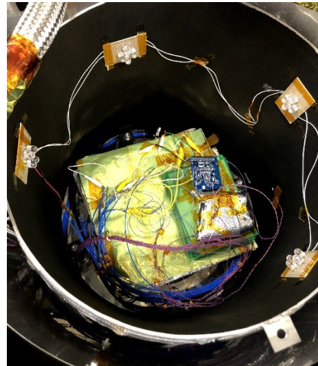
図 6.8 各種電子基板の低温真空試験
