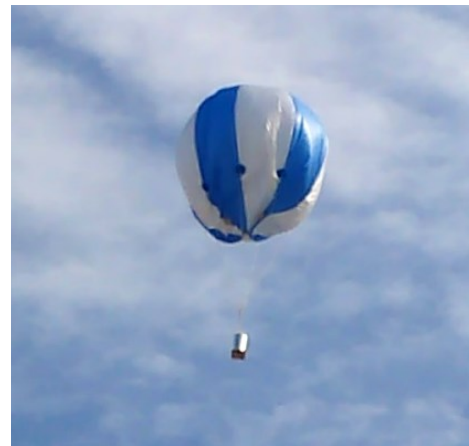
(b) 気球の下に取り付けてある衛星格納ポッド
