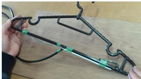
図2 ハンガーを使ったアンテナの外観
