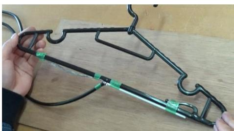
図2 ハンガーを使ったアンテナの外観
