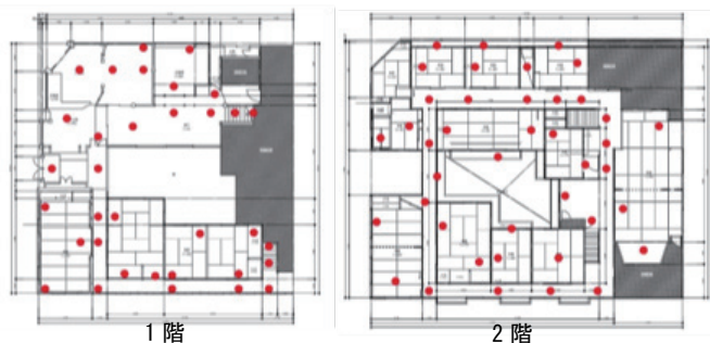
図 2 BLK360 の計測点（網掛け部は調査範囲外）
