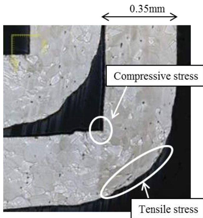
図 3.3 3DBC の断面観察図
