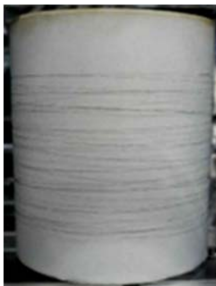
図 2-10 ロープ状 CNT 撚糸をロールに巻き付けたもの 30)
