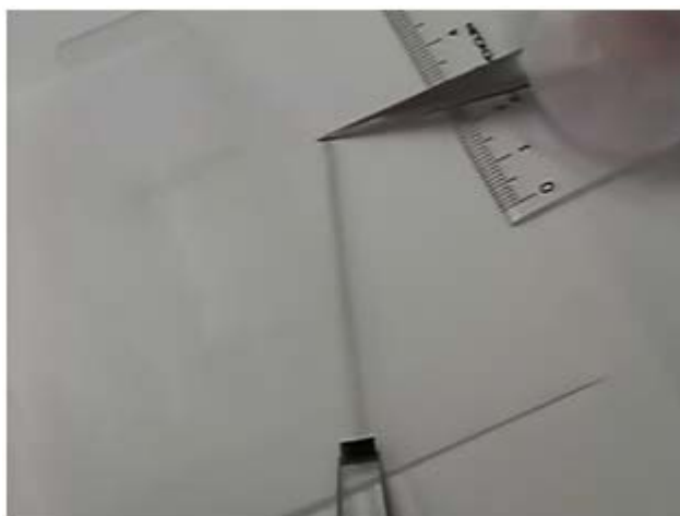
図 2-9 ロープ状 CNT を引き出しているところ
