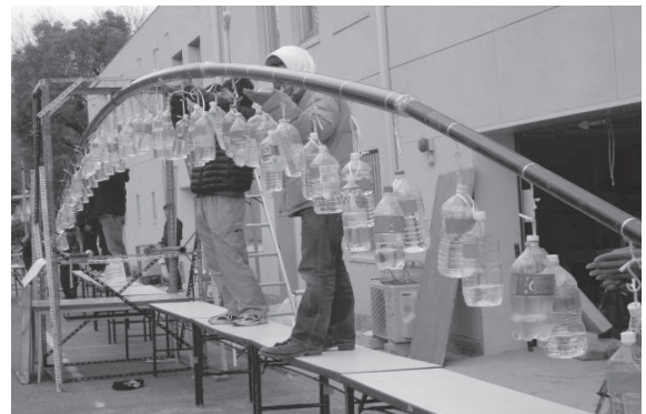
写真-3 主翼主桁強度・剛性試験
