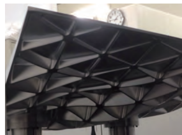
第3図 アイソグリッド構造のプロトタイプ
