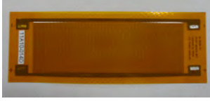
Fig. 2 Macro-fiber composite (MFC) actuator. 1
