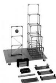
(a)構造物可視化 振動実験装置
