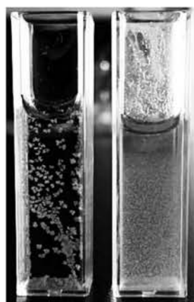
図9 ニンヒドリン法測定後の試料 (左: 攪拌なし, 右: 1分おきにセルを攪拌)
