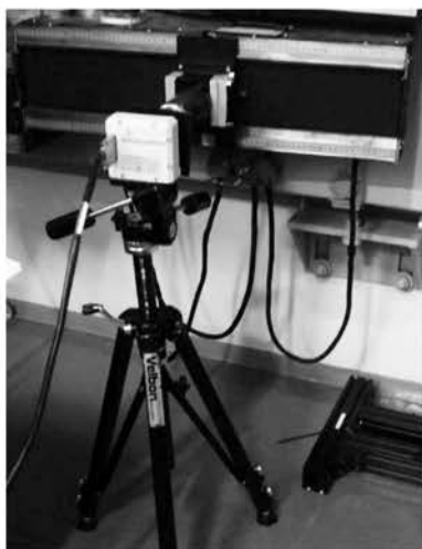
図 2 高速度カメラを分光器出口に取り付けたところ (著者撮影)
