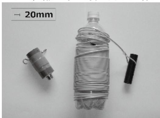
図 2 製作したアンテナ
