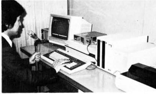
図1 音声入出力装置の外観
