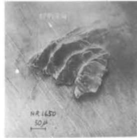
図-6(c) せん断形切りくず(表) 1650m/min(焼ならし)×100
