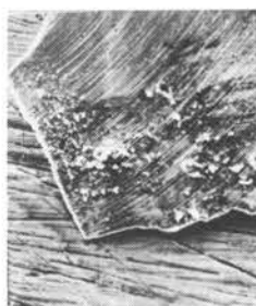
図-5(b) 扇形状切りくず 490m/min(焼入れ)×500
