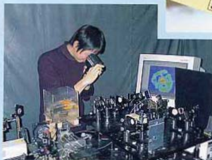
近赤外レーザー光を用いた光断面画像測定
