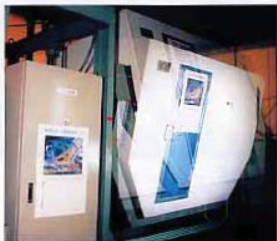
乗り心地シミュレータを用いた動揺実験
