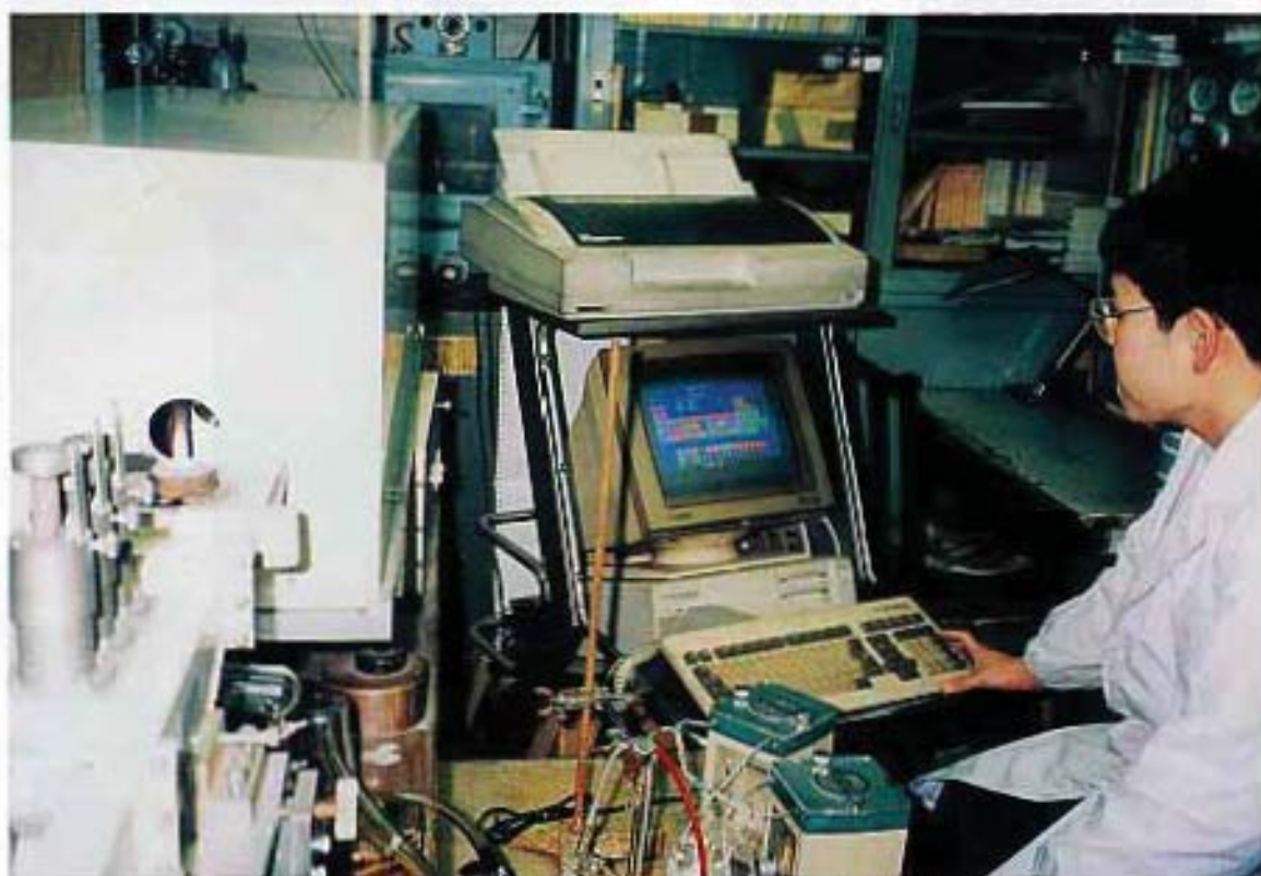
プラズマ発光分析法による微量元素分析
