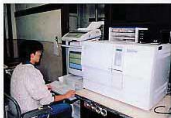
セラミックス焼成過程における脱ガス分析
