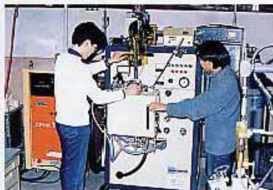
アーク溶解炉を用いた先端材料の創製
