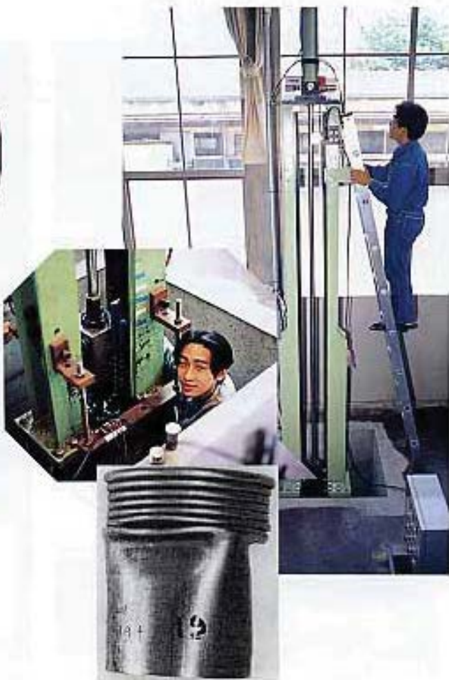
大型衝撃区間試験装置および圧縮試験後のサンプル形状。材料や構造物に衝撃荷重が負荷されたときの力学的特性や破壊挙動を調査するための基礎研究を行っています。
