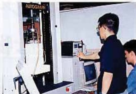
材料の高温変形の実験
